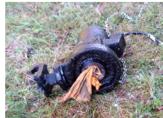
Feststoffe verursachen Verstopfungen im Kanalnetz.
